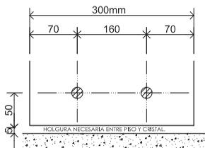
DISTANCIA DE BARRENADO DE CANTOS DE CRISTAL A CENTRO DE BARRENO PARA ANGULO SOPORTE ALETA SQUASH 300mm.
