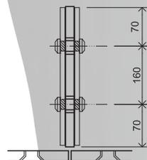
VISTA EN PLANTA DE SUJECION DE PLACA DE EXTENSION 300MM EN COSTILLA SQUASH DE 300MM.
