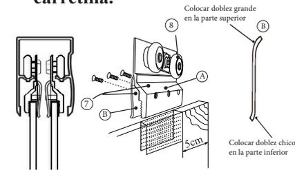
Atornille la pieza de aluminio y la pieza de acero, coloque el empaque de neopreno sobre el canto superior del cristal a 5 cms del canto vertical, inserte encima del empaque la carretilla ya armada y ajuste los tornillos firmemente.
