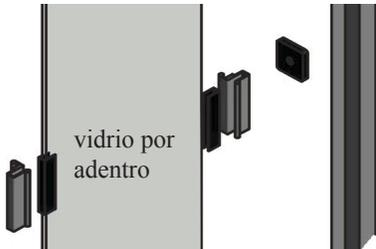
Para la instalación de las jaladeras interiores coloque uno de los empaques de neopreno en el canto del cristal a la misma altura que el toallero y doble el empaque hacia ambas caras del cristal, inserte la jaladera y presiónela hasta que embone perfectamente.
