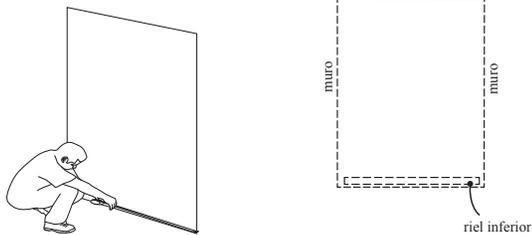
Mida el ancho del claro entre muros a nivel de piso y corte el riel inferior 2 mm más corto que la medida obtenida.
