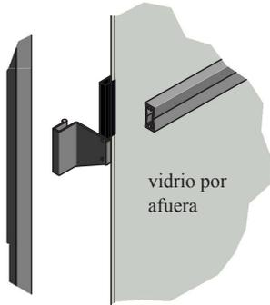
Corte el perfil toallero 43mm más corto que el ancho del cristal e inserte en cada uno de los lados del perfil los brazos, atornille el toallero a las jaladeras del toallero con las pijas, repita la operación en el otro lado, coloque uno de los empaques de neopreno en el canto del cristal a la altura deseada cubriendo el canto y doblando hacia ambas caras del cristal.
