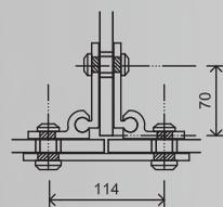
VISTA EN PLANTA DE SUJECION DE PLACA 3 BARRENOS A ANGULO ARTICULADO LARGO Y MEDIO ANGULO A COSTILLA.
