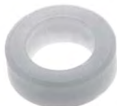
5406 CASQUILLO Ø 25mm P/TORN 3/8", PARA CRISTAL DE 9.5 ó 12.7mm.
